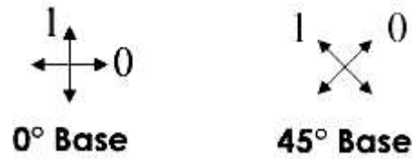
Figura 1.3: Dues bases per enviar fotons, basades en la seva polarització.
