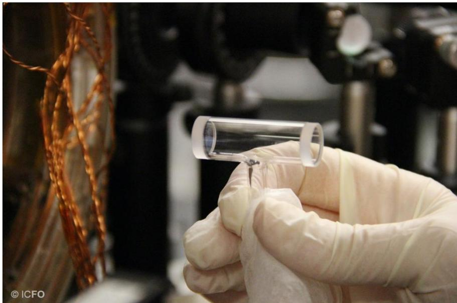
*Leyenda: Imagen de la celda de vidrio donde se mezcla el metal de rubidio con gas nitrógeno y se calienta hasta 450 grados Kelvin. A esa temperatura alta, el metal se vaporiza, creando átomos de rubidio libres que se difunden dentro de la célula. Crédito de la imagen: © ICFO*
